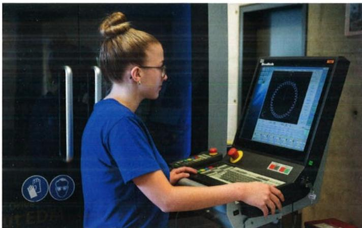
^ **Usinage CNC** Les coordonnées (mesures et cotes) de la pièce à usiner sont introduites dans le programme. La machine fait le reste.
