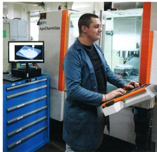
◀ **Fraisage** Les écrans de contrôle permettent au micromécanicien de suivre les différentes opérations de haute précision effectuées par la machine.
