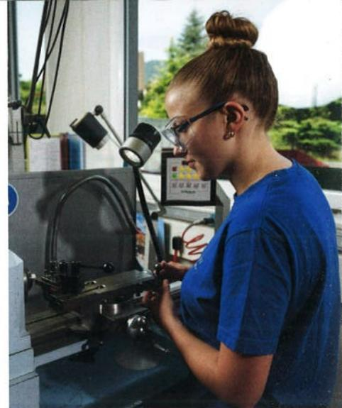
Le travail au tour permet de créer une pièce d'une grande précision à partir d'un cylindre métallique.
